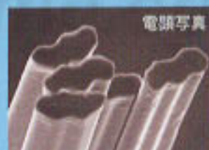
電顕写真 テクノファイン with UV ブロッキングの断面写真
